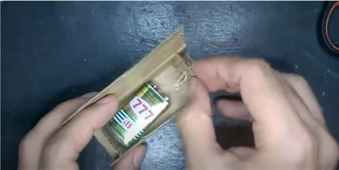
Con el pegamento colocaremos el compartimiento donde colocaremos los LED
