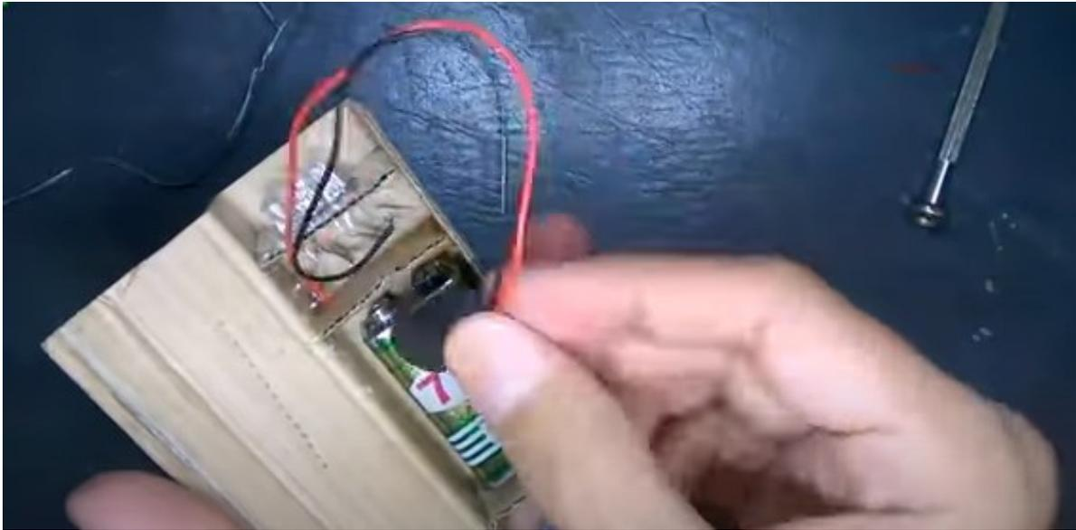
En la imagen podemos observar cómo debe quedar la linterna de cartón como pueden ver no coloque ninguna resistencia los tres led van directo a la batería, colocados en serie y respetando la dirección de los led
