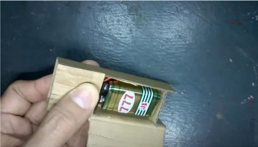
Una opción de como la podemos terminar es cortar para que cuando abramos sea para cambiar la batería, y la parte de arriba no se vea, colocamos silicón y nada más nos queda la ventana de abajo
