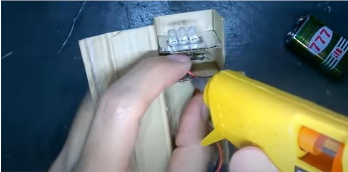
La parte donde se encuentran los led es importante que la separen y con un trozo de madera realizar otro compartimiento con la finalidad de fijar los conductores
